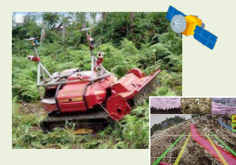
自動運転下刈り機械と運行監視モニター
