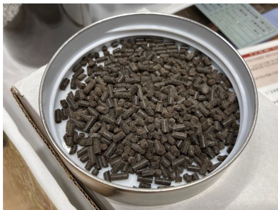
▲緑水工業が市の補助金を使って試験製造した下水由来肥料のペレット
