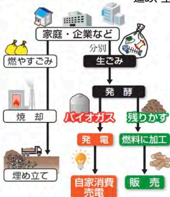
生ごみバイオガス発電の流れ
