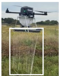
水路に繁茂するナガエツルノゲイトウに塗布型ノズルでの薬剤処理の様子
