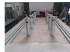
R7d杭を対象とした大型模型実験
