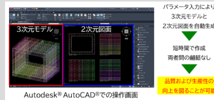
Autodesk® AutoCAD®での操作画面 BIM/CIM配筋モデル自動生成ツール (大林組、建設技術研究所、八千代エンジニアリング、TerraDrone)
