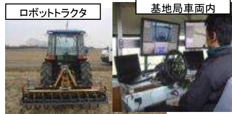
ロボットトラクタ 基地局車両内 ロボットトラクタによる表土削り取り技術の開発
