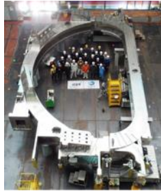
超大型超伝導コイル用構造物
