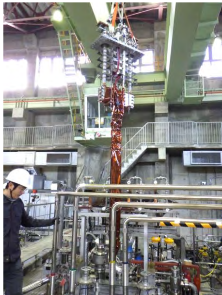
← 大型導体試験装置における高温超伝導導体試験
