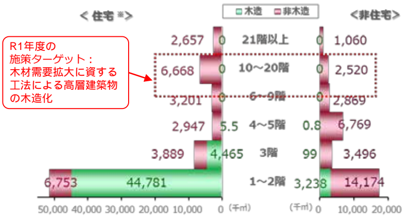
【構造別・階層別新築建築物の床面積(住宅※・非住宅, 2019年次)】
