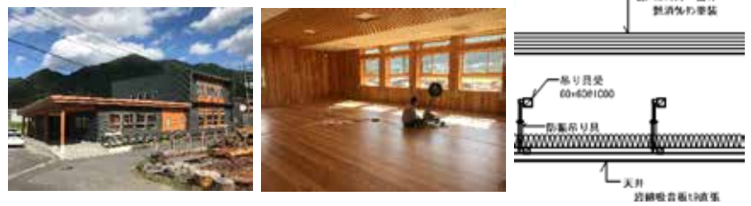
【測定対象物件写真および床断面図 (CLTパネル床と防振吊り具の天井を用いた事務所)】
