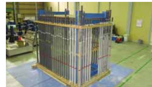
冬季における、あと施工アンカーの施工実験
