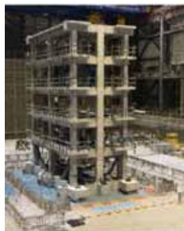
【実大5層剛節架構】
