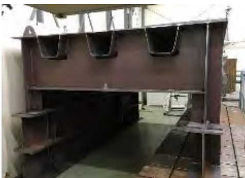
輪荷重走行試験体
