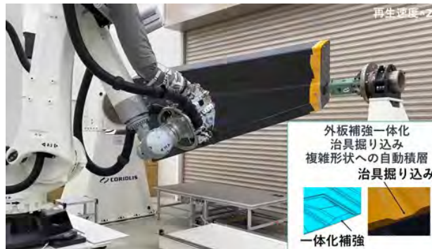
自動積層装置と翼型構造の試作
