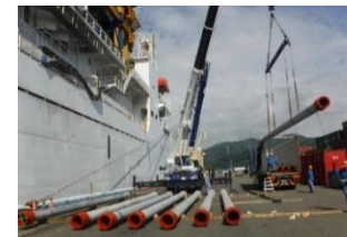
レアアース採掘に使用する 6,000m揚泥管組立・搭載関連
