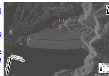
図-1 小型衛星の堤体観測結果 （強度画像 QPS-SAR Spotlightモード）
