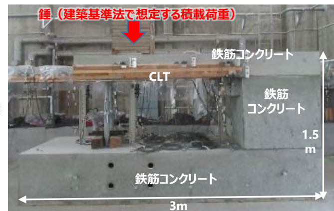
CLTとRC造の合成床試験体の長期性能確認実験
