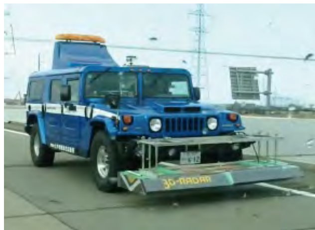
図 3-98 橋梁床版の高速・自動レーダー診断技術
