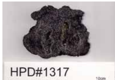
掘削した孔口付近に析出したチムニーのサンプル（多量の重金属を含む）
