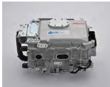
<PCU に新素材 SiC パワー半導体を搭載したカムリ試作車 (左)、PCU (右) >
