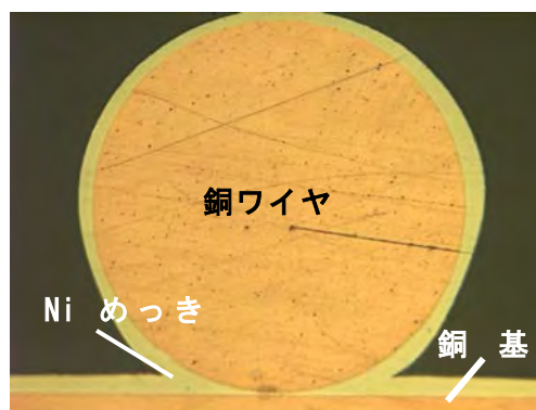
図4. Ni めっきで接合した銅ワイヤ/基板の接合界面性状
