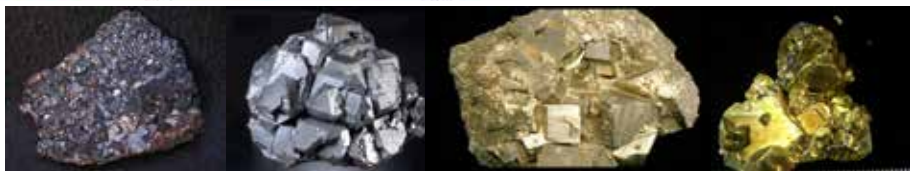
閃亜鉛鉱(ZnS) 方鉛鉱(PbS) 黄鉄鉱(FeS 2 ) 黄銅鉱(CuFeS 2 )
