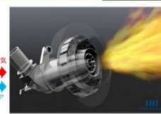
アンモニア混焼ボイラ概略図 （既存ボイラを一部改造することで対応）
