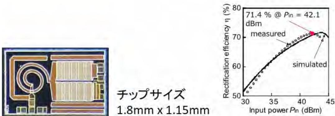
図 2-2-54 開発した 5.8GHz 帯 10W 級整流器 IC とその特性
