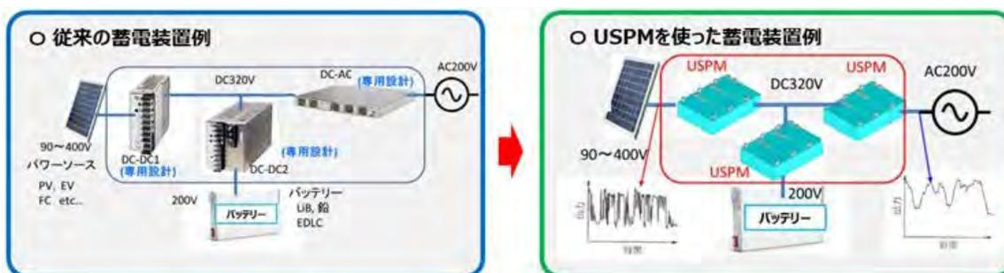
図 2-2-22 USPM の概略イメージ図
