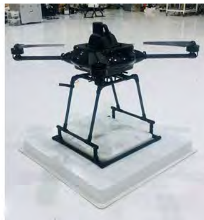
図 2-3-24 製作した受電部搭載ドローン及び止まり木型充電ポート (左図)と低背型ポート(右図)
