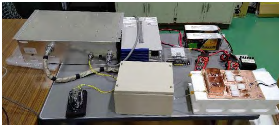
図 2-3-22 製作したドローン WPT システムの疑似結合器
