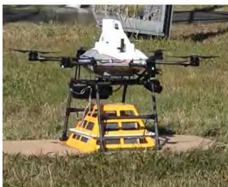
図 2-3-24 製作した受電部搭載ドローン及び止まり木型充電ポート (左図)と低背型ポート(右図)
