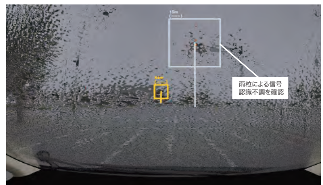
図22 DIVPシミュレータによる信号認識限界の検証
