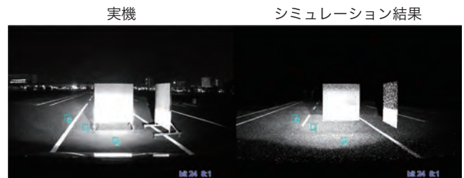
図14 ヘッドライト路面反射の最適化による夜間映像再現
