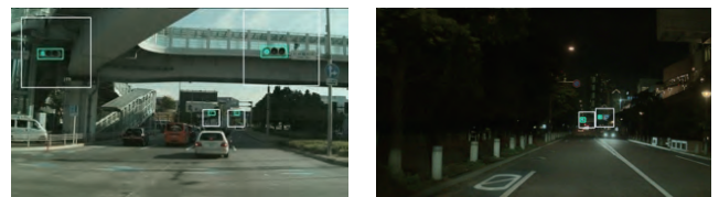
図4 信号機の認識結果例
