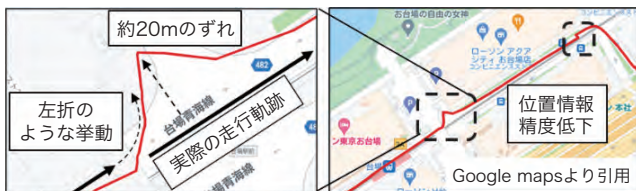
図3 V2N模擬緊急車両位置情報取得データ例
