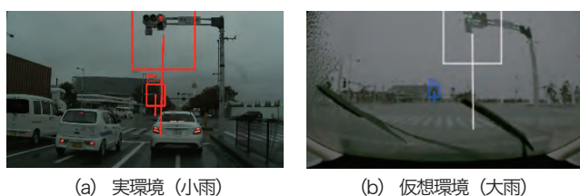
図7 仮想環境を用いた雨天時の限界性能評価
