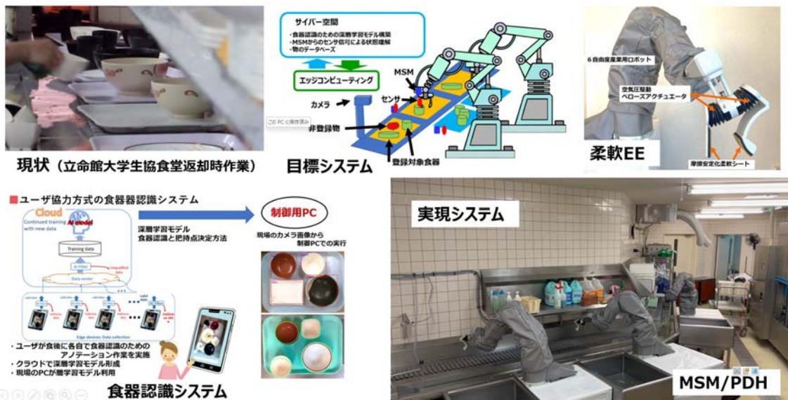
図表 2-(5)-8 大規模食堂の食器回収システム
