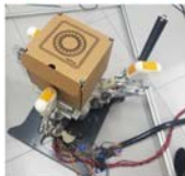
図表 2-(5)-7 人機一体エンドエフェクタ実証実験例その1
