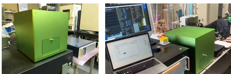
図 2-1-10. CAD データの投入のみで最適なレーザー加工が可能なスマートレーザー加工機システム
