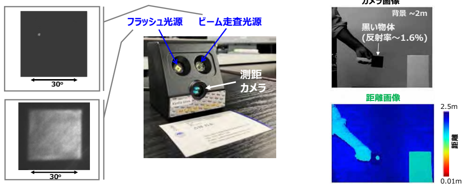
図 2-3-16. 電子的(非機械式)ビーム走査フォトニック結晶レーザーおよび光学系フリーフラッシュ照射フォトニック結晶レーザーの開発と、新たなLiDARの構築(左)。測距(黒い物体の追尾・検出)の様子(右)
