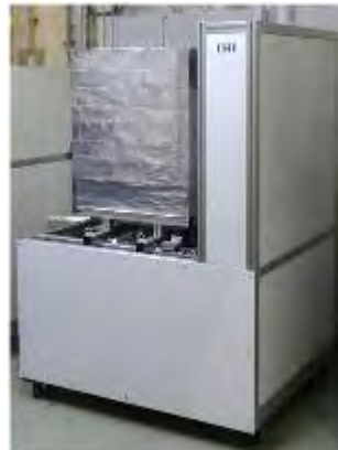
図 3-50 燃料電池システムの外観
