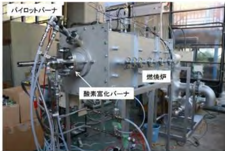
図 3-53 10kW モデル燃焼炉（正面）
