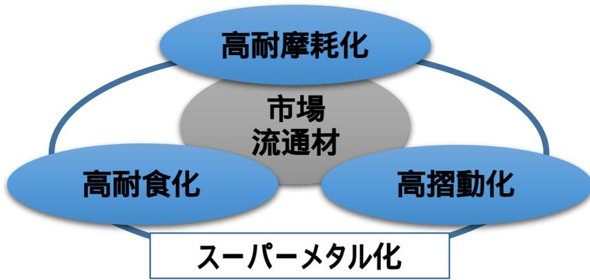
**高耐摩耗化** 浸硫窒化処理により、耐摩耗性が向上することを確認
