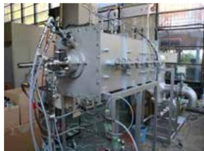
10kW モデル工業炉
