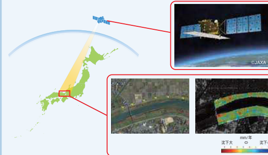
衛星SAR技術を使った現場検証の取り組み *1 SAR: Synthetic Aperture Radar (合成開口レーダー)
