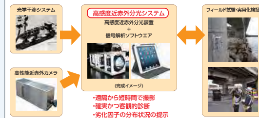
遠方から短時間かつ安価にコンクリート劣化成分の分析ができる近赤外イメージング技術
