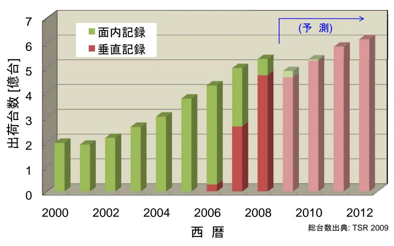
ハードディスク装置(HDD)の世界出荷台数と垂直記録方式の割合の年次推移
