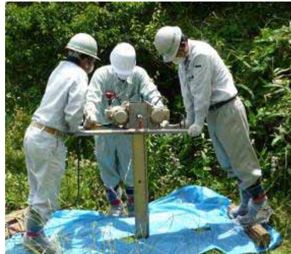
(b) ハンディジオスライサー (幅10 cm×深さ1.0m×厚さ2cm ) による土壌採取の状況
