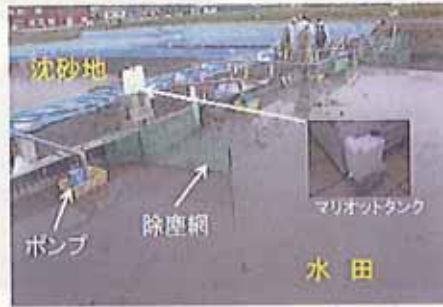
2) 沈砂地およびポンプ配置
