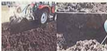
図2：改良型二段耕プラウ（耕深45cm、トラクタ牽引）：中央研ほ場、8月29日実施
