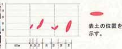
図2：改良型二段耕プラウ（耕深45cm、トラクタ牽引）：中央研ほ場、8月29日実施
