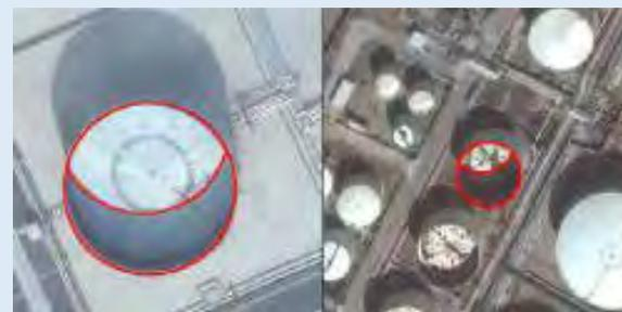
石油タンクの蓋に映し出された影を分析し、世界中の石油在庫量を推計。
