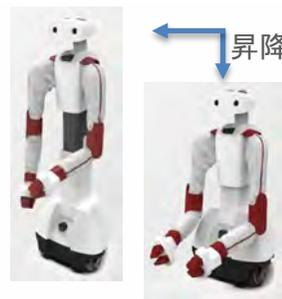
効率よく動作学習し自律動作し、転移学習可能なコンパクトなロボット (AIREC-Basic) を開発
