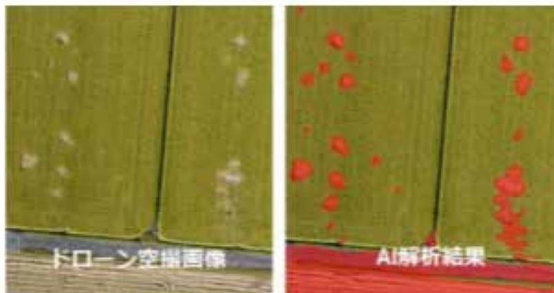
図 2-60 ドローン空撮画像と AI 画像解析による害虫発生場所の特定
