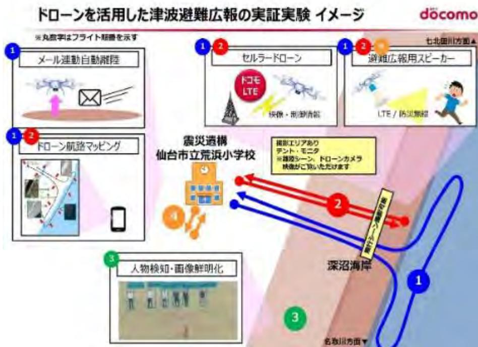
図 2-61 ドローンによる津波避難広報の実証実験概要
