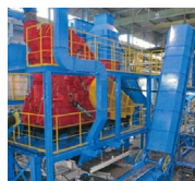
金属破碎・選別設備
