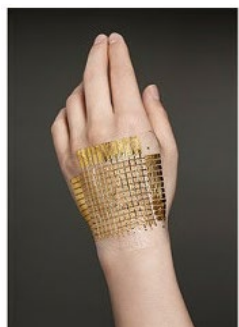
1マイクロメートル程度の極薄の高分子フィルムに有機デバイス
