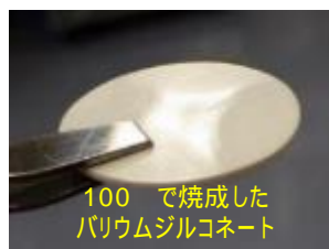
革新的低温焼成技術 100 で焼成した バリウムジルコネート
