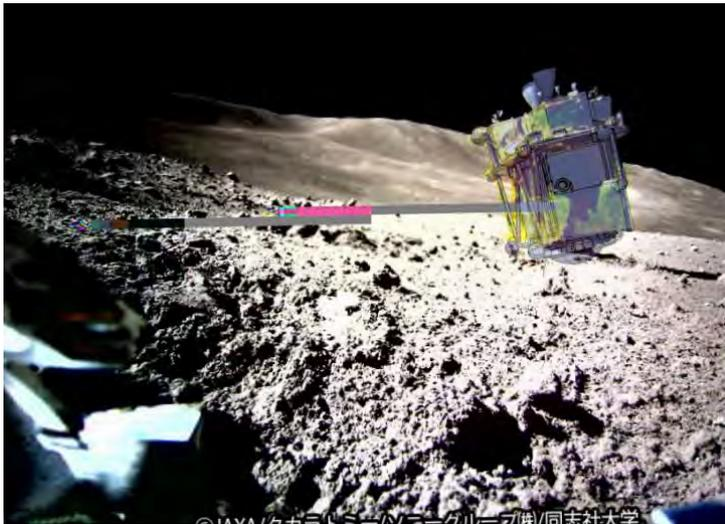
LEV-2が撮影し、LEV-1経由で地球に直接送信されたSLIMの月面への着陸状態の写真
