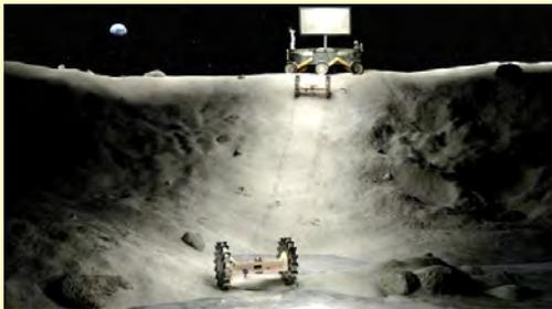
小型ロボット群の自律移動と相互通信技術を開発,2024.4にNASA JPLのIM-3プロジェクトで月面に到着予定。
