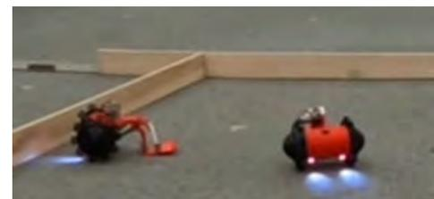
探査用小型ロボットのプロトタイプ
