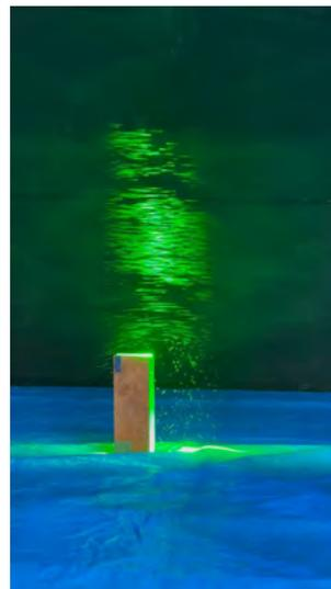
都市内部への介入を模擬するための準備として、縮尺模型実験によって、構造物周辺の風速パターンを3次元的に計測
