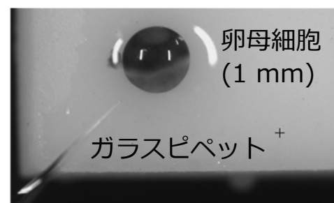
センサを統合した マイクロツール (分解能: 0.62 \mu\text{N} )
