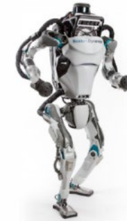
Atlas (Boston Dynamics) 14自由度（上半身）、 可搬重量11kg、 油圧駆動
