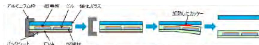
太陽光パネルの低コスト分解処理のイメージ
