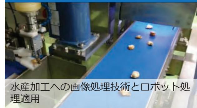
水産加工への画像処理技術とロボット処理適用
